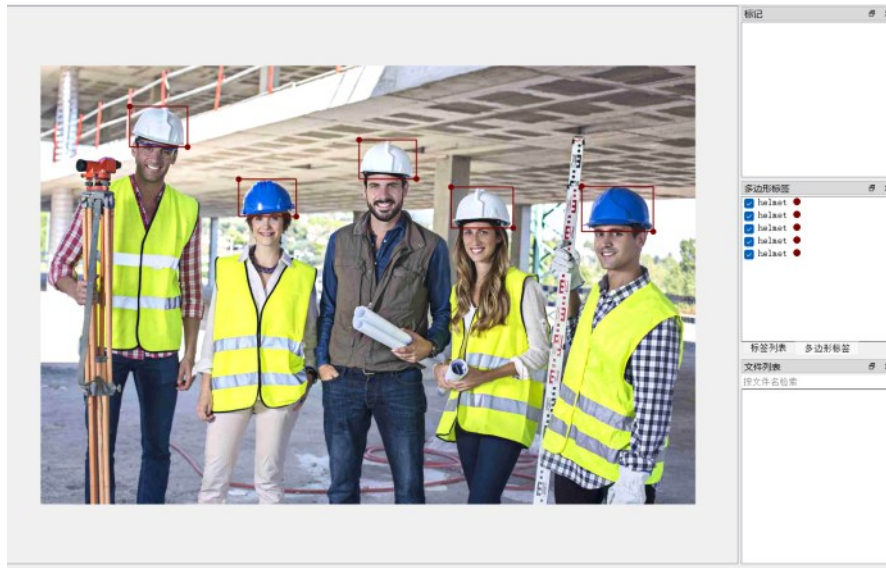
图4 使用标注软件对是否佩戴安全帽进行画框标注
